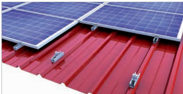
System zaciskowy: montaż poziomy na mostkach krótkich
