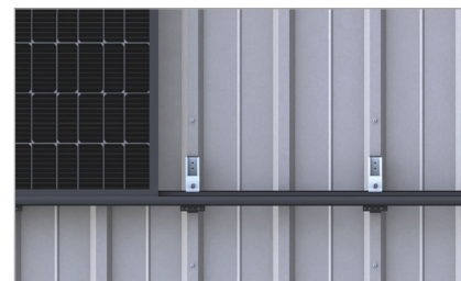
Mocowanie mostka krótkiego na fasadzie
