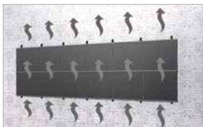
Zeer goede ventilatie van de zonnepanelen
