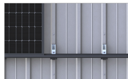
Fixation des profilés courts sur la façade
