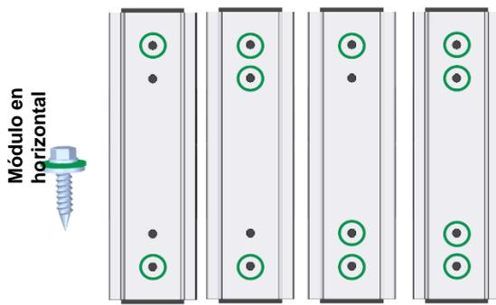
El cálculo estático en la planificación de la instalación define la cantidad de elementos de fijación necesarios para el montaje de los módulos en horizontal.
