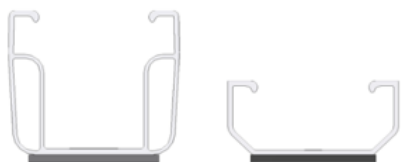
Kortprofil C47 med EPDM 385 mm
