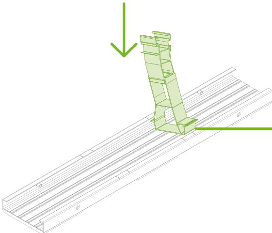
**A** K zaváknutí podpěr použijte nástroj pro montáž a demontáž.
