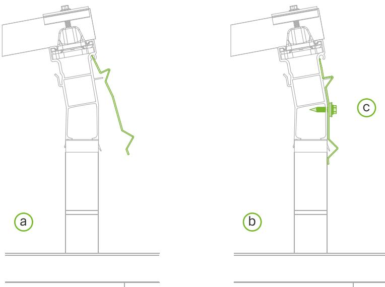
**A** Namontujte příčný nosník na podpěru modulu.
