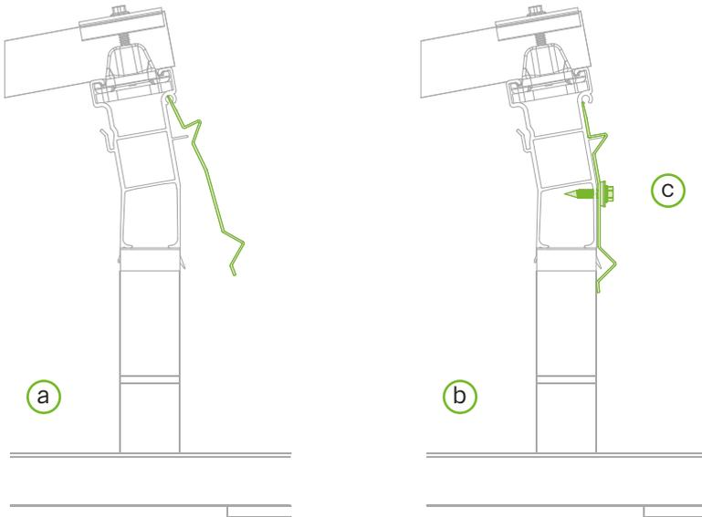
**A** Montar la barra transversal en el apoyo del módulo.
