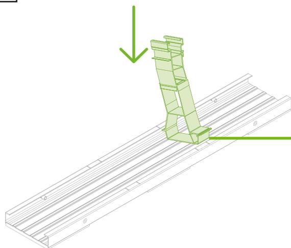
**A** Utilizar la herramienta de montaje y desmontaje para encajar los apoyos.
