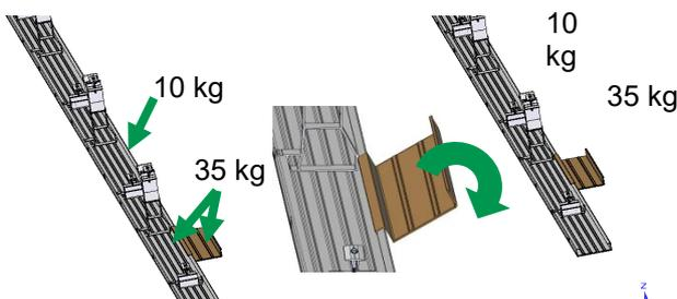
El montaje de bandejas para lastre permite insertar o colocar con seguridad piedras de tamaño pequeño o grande cuando sea necesario. Las bandejas para lastre se enganchan en el lateral de las bases.
