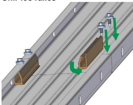
Unir bien los extremos de los raíles, empujar el conector debajo de las almas y atornillar con 2 tornillos respectivamente.
