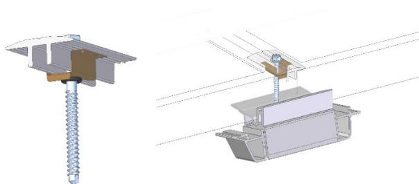
Introducir y desplazar la chapa de contacto por la pestaña de empuje, encima de las almas de la placa de fijación de las pinzas intermedias, hasta el tornillo. Observar el par de apriete descrito anteriormente. La chapa de contacto sirve para compensar el potencial y para dotar al sistema de capacidad de absorber corrientes de rayo.
