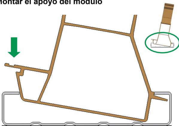
Insertar el componente en la base por un lado, tal como se muestra, y encajarlo en la base con un clic.
