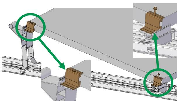
Fijar los módulos al final de la hilera o en las interrupciones de las hileras (claraboyas, ventiladores, o similares) con el set de pinza de módulo E-K.
