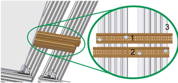
Unir los bloques de módulos adyacentes con dos perfiles de acoplamiento; para ello, fijar el primer perfil de raíl (1) con dos tornillos en la base izquierda, a continuación fijar el segundo perfil de raíl (2) en la base derecha. Dejar el extremo suelto del perfil de acoplamiento que sobresalga del borde de la segunda base (3).
