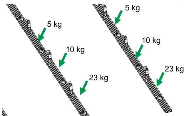
Después de montar los módulos, colocar piedras de lastre en o sobre las bases de acuerdo con el plan de lastre. El lastre necesario depende de la zona de la instalación y en el plan de lastre puede indicarse en kg y/o cantidad de piedras. El lastre puede tenderse debajo, delante o detrás del módulo para acomodar el lastre necesario. La elección de la piedra de lastre se realiza en el terreno, y las dimensiones deben adecuarse al peso indicado del lastre.
