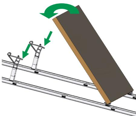
Colocar el módulo en transversal sobre los pies de base y a continuación depositar el módulo sobre el set de apoyo del módulo.
