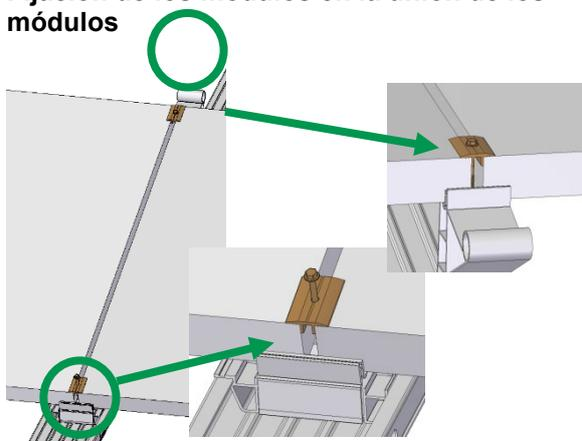
El módulo siguiente se coloca sobre el pie de base o el apoyo del módulo. Ajustar la separación entre los módulos (12 mm) insertando el set de pinza de módulo M. Insertar la pinza de módulo de tal manera que el tornillo perforador se introduzca en el orificio del pie de base o del apoyo del módulo.
