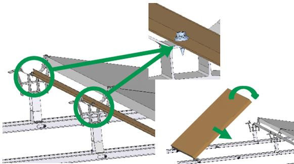
Una vez fijados los módulos, tender la tira de tracción en el soporte del módulo y atornillarla con un tornillo. Montar la unión de la tira de tracción de manera solapada en el set de apoyo del módulo.
