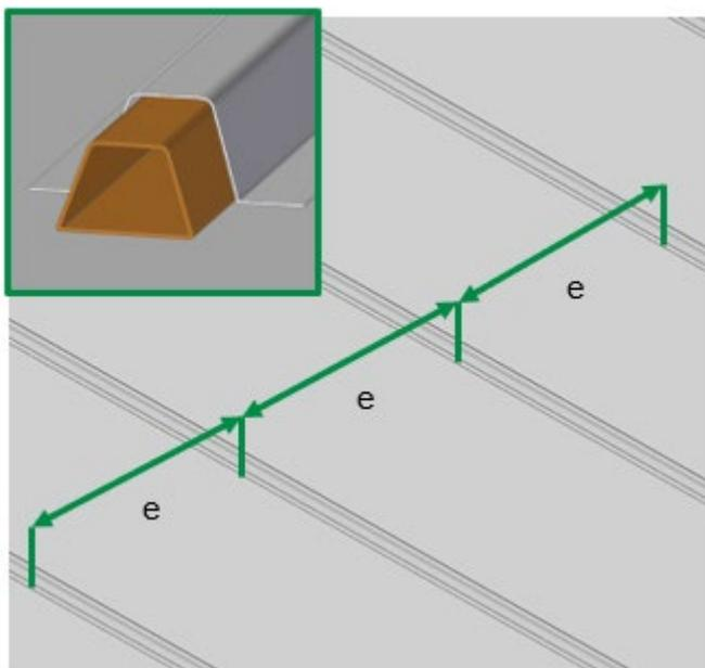
La subestructura novotegra para cubierta plana II se monta sobre perfiles de aluminio (perfil RubberSolar TPO) soldados a la impermeabilización de la cubierta. El sistema es adecuado para las membranas de techo TPO Sintofoil de Imper Italia SRL. Los perfiles deben ser soldados a la membrana de impermeabilización del tejado por especialistas cualificados según las especificaciones del fabricante.
