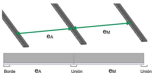
Como alternativa, tender el primer raíl en el borde de la instalación/hueco de dilatación enrasado con los módulos, y colocar los demás raíles centrados debajo de la unión de los módulos.
