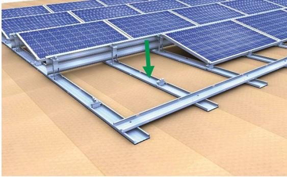
Para la versión orientada al sur, debe instalarse un tercer carril de base a partir de una longitud de módulo de  $\geq 2,18$  m.
