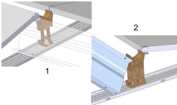
Apoyo deflector de viento-módulo (1): Colocar el deflector de viento debajo del módulo, fijar el módulo y el deflector de viento en la base con la pinza de módulo E-K y con otros dos tornillos.
