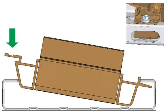
Insertar el componente en la base por un lado, tal como se muestra, y encajarlo en la base con un clic. Si el pie de base está colocado sobre un orificio oblongo, debe asegurarse siempre con un tornillo.
