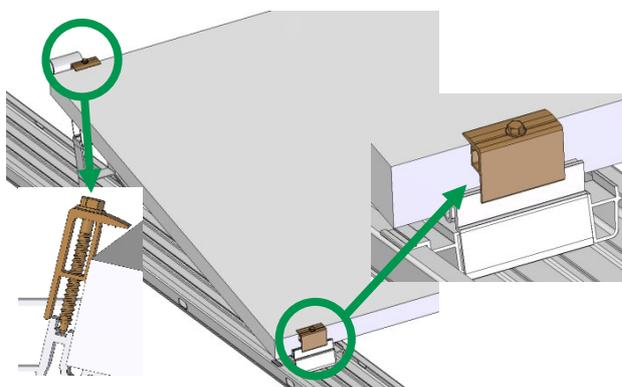
Colocar y enroscar el tornillo perforador del set de pinza de módulo E centrado en el canal de atornillado del pie de base o del apoyo del módulo.
