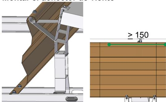
Guiar el deflector de viento desde arriba, por encima de la curvatura del apoyo del módulo, y colocarlo sobre las bases. Montar el deflector de viento contiguo del módulo siguiente solapándolo al menos 150 mm con el primer deflector. Fijar los deflectores de viento con dos tornillos por cada base y con un tornillo en la curvatura del apoyo del módulo.
