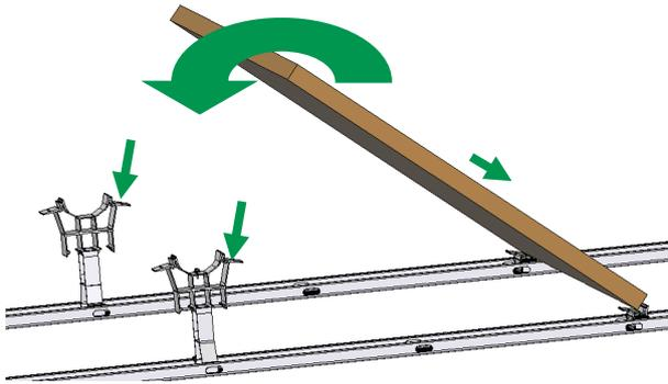
Colocar el módulo sobre los pies de base en sentido transversal y, a continuación, depositar el módulo sobre el set de apoyo del módulo. Los módulos de una hilera doble deben tenderse por ejes, es decir, primero debe montarse un lado del módulo.
