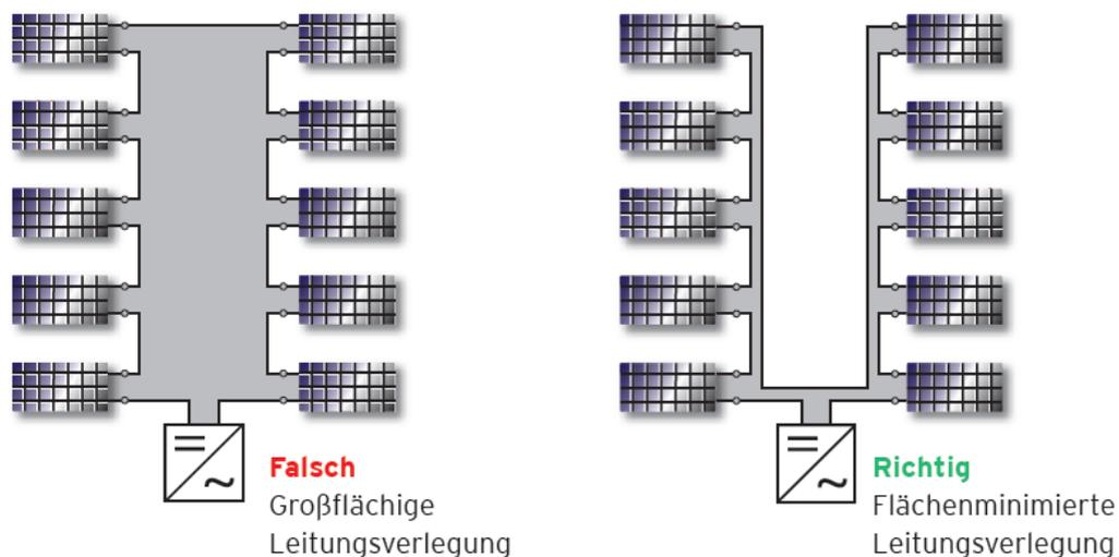
Abbildung 67: Richtige Leitungsverlegung – Vermeidung von Leiterschleifen
