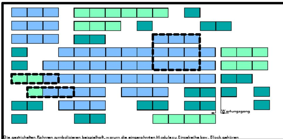
Abbildung 18: Beispiele für Einzelmodule, Modulreihen und Modulblöcke
