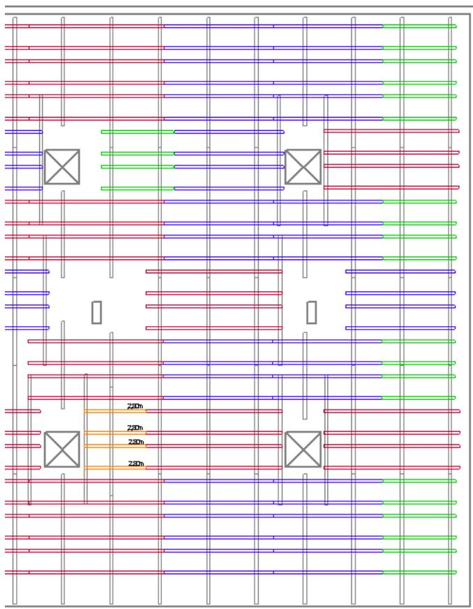
Abbildung 22: Montageplan Basisprofile (Planausschnitt als Beispiel)
