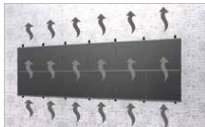
Buena ventilación trasera de los módulos
