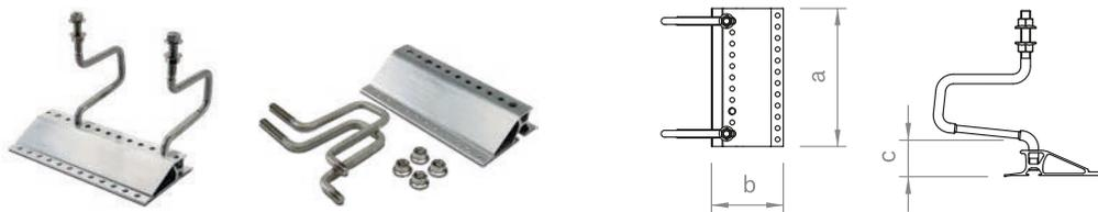
Ganci per tetto per il montaggio di guide a C come binari orizzontali, ottimizzati per carichi pesanti, connessione tra guida e gancio per tetto regolabile in altezza fino a 35<sup>°</sup> mm, connessione tra gancio per tetto e profilo di base regolabile in altezza per listelli da 24 - 30 mm o 31 - 40 mm, per sovrapposizioni di tegole fino a circa 95 mm, a seconda del tipo di tegola.
