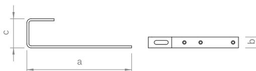
Gancio per tetto per il montaggio di rotaie C-N o rotaie C come binari verticali e orizzontali su tetti con copertura in ardesia o in scandole, collegamento rotaia-gancio per tetto con. Adattatore a L con scanalatura 11 × 41 mm o come set con vite a testa tonda M10, con superficie di appoggio piatta.
