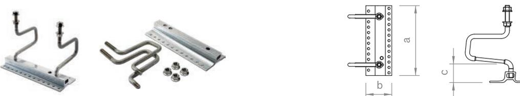
Gancio per tetto per il montaggio di rotaie a C come binari orizzontali su tetti a tegole, ottimizzato per carichi pesanti, collegamento rotaia-gancio per tetto regolabile in altezza fino a 35 mm, collegamento gancio per tetto-profilo di base regolabile in altezza per listelli da 24 a 30 mm, per la formazione di tegole doppie a coda di castoro.
