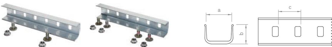
Giunzione binari a C47 con viti a testa tonda e dadi flangiati con testa esagonale SW 18. Disponibile anche nel modello con giunzione di dilatazione con quattro viti a testa tonda.
