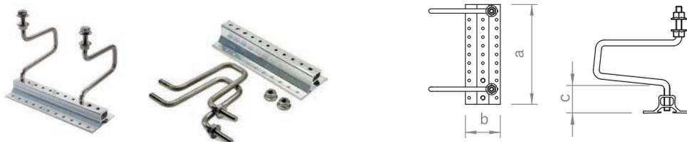
Ganci per tetto per il montaggio di guide a C come guide verticali e orizzontali, collegamento guida-gancio per tetto regolabile in altezza fino a 35 mm, collegamento gancio per tetto-profilo di base regolabile in altezza per listelli da 24 - 30 mm o 31 - 40 mm, per sovrapposizioni di tegole fino a circa 95 mm, a seconda del tipo di tegola.
