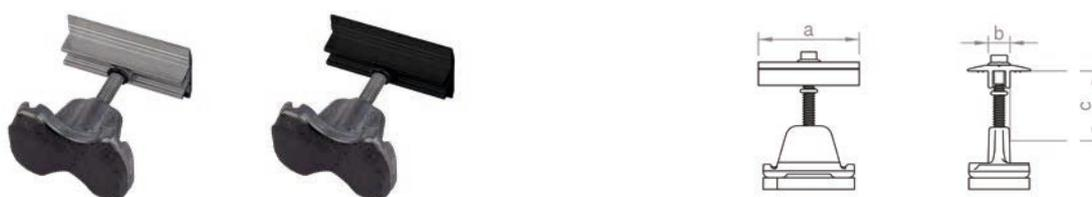
Morsetti centrali per il fissaggio dei moduli sulla guida C o C-N. Facile da installare grazie al meccanismo a scatto. Vite di fissaggio con attacco esagonale 8 AF. Per altezze del telaio di 30-42 mm o 43-52 mm, disponibile in versione bianca o anodizzata nera.
