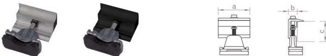
Morsetto terminale per il fissaggio dei moduli alla guida C o alla guida C-N. Facile da installare grazie al meccanismo a scatto. Vite di fissaggio con attacco esagonale 8 AF. Per altezze del telaio da 30 a 42 mm o da 43 a 52 mm, disponibile in versione bianca o anodizzata nera.
